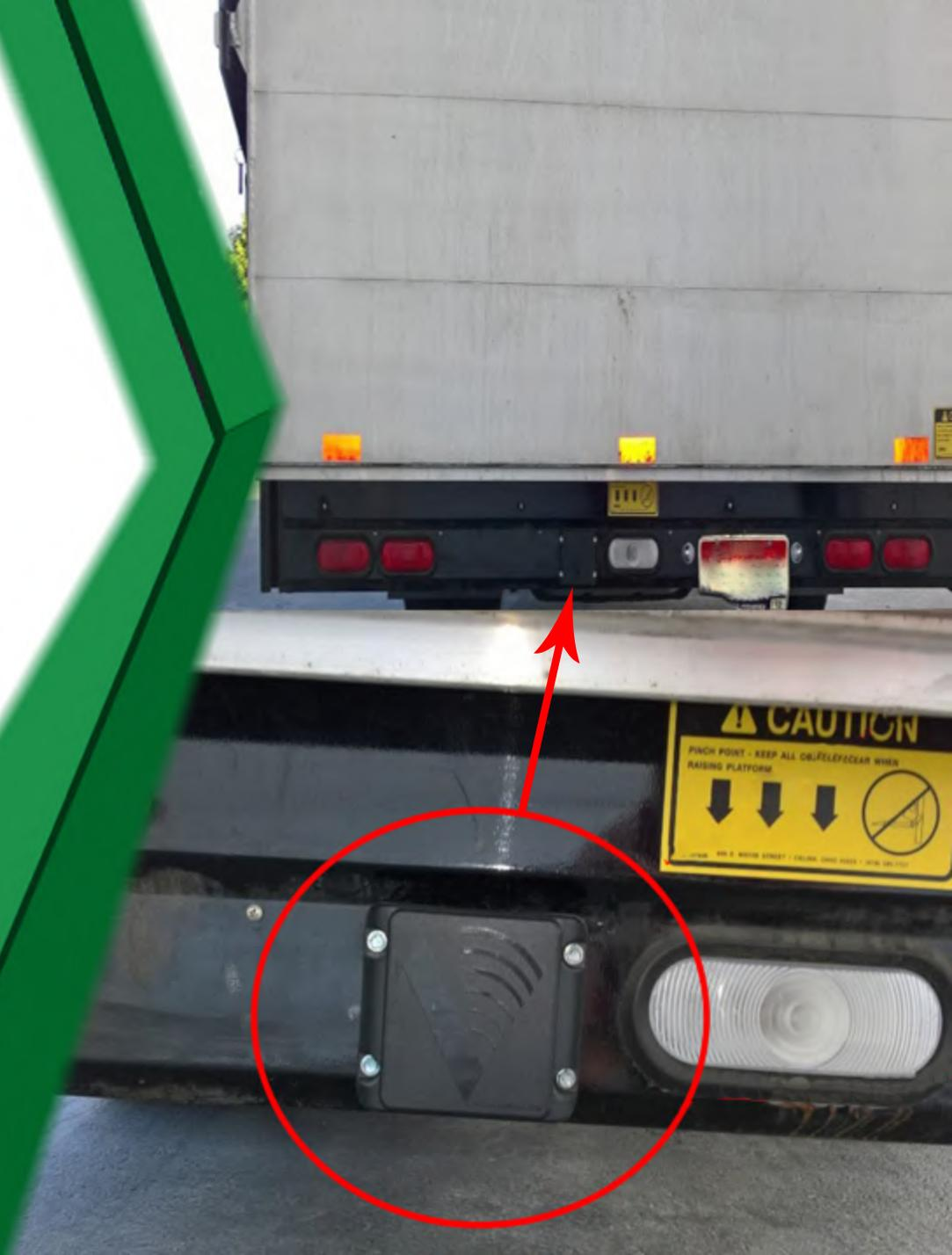
**Il sensore PreView Sentry® è completamente configurabile e in grado di individuare oggetti dalla superficie del radar fino a una distanza di 30 metri. L'ampiezza di rilevamento è regolabile su qualsiasi tipo di veicolo.**
