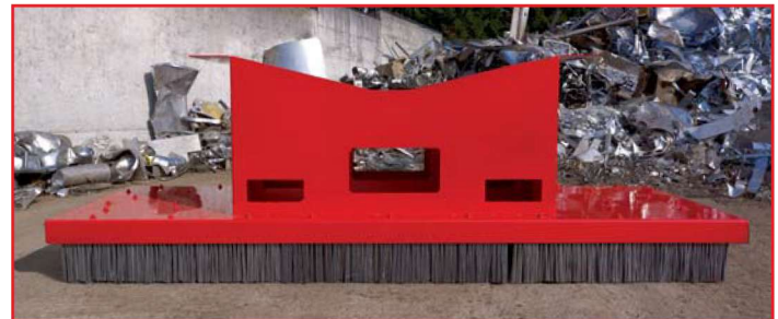
Scopa Industriale Mod. 3 mt Attacco Forche + Pinze: Larghezza 3000 mm Lunghezza 1000 mm Altezza 1100 mm Peso 540 kg
