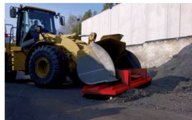
Scopa Industriale Mod. 4 mt Attacco Pala: Larghezza 4000 mm Lunghezza 1000 mm Altezza 750 mm Peso 1200 kg
