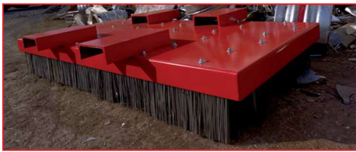
Scopa Industriale Mod. 2 mt Attacco Forche: Larghezza 2000 mm Lunghezza 1000 mm Altezza 350 mm Peso 304 kg
